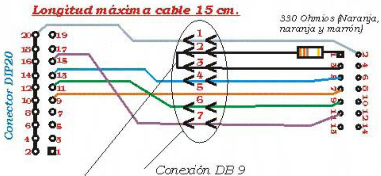
Puente entre pin 2 y 3 del DB 9 hembra para cerrar contacto entre los pin 1 y 3 del Jtag del deco a traves de la resistencia de 330 ohmios.
